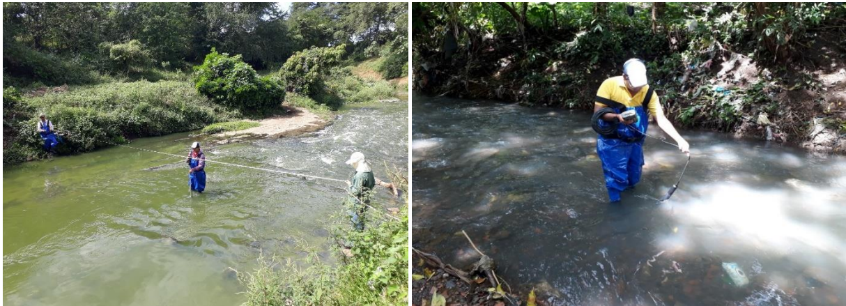
Personal de ANA realizando el monitoreo en el río Pochote, León. Izquierda: aforo en el río. Derecha: medición de parámetros fisicoquímicos de campo con sonda multiparamétrica.
